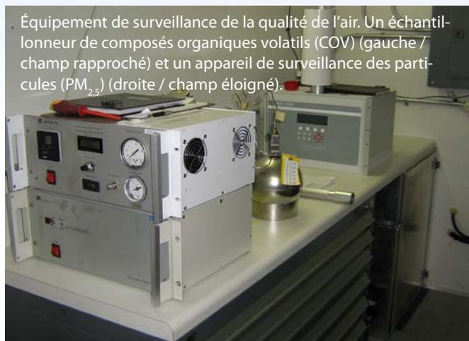
Équipement de surveillance de la qualité de l'air. Un échantillonneur de composés organiques volatils (COV) (gauche / champ rapproché) et un appareil de surveillance des particules (PM<sub>2,5</sub>) (droite / champ éloigné).
